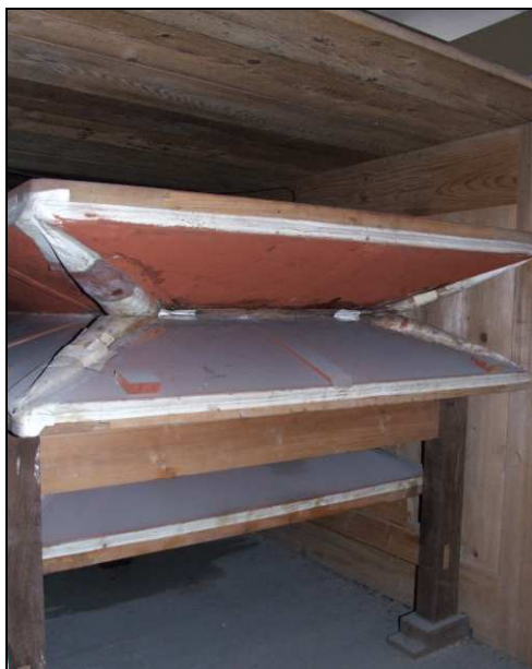
12. kép: A fúvó előregedett bőrzése
