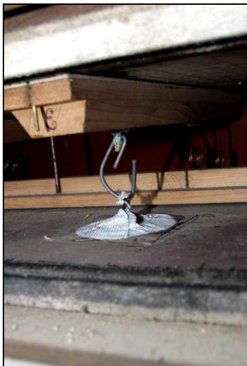
7. kép: A pedál szelepszekrény idegen anyagú pulpétázása
