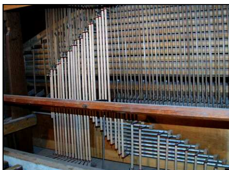
11. kép: A pedálkopula kialakítása
